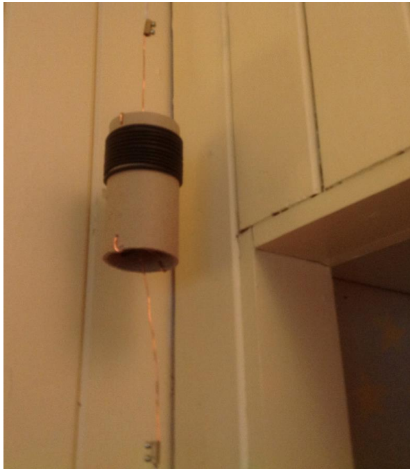
Fig. 8 Detailopname van de verlengspoel. In de spoel zit nog een parallelcapaciteit van 54pf, 3600V.
