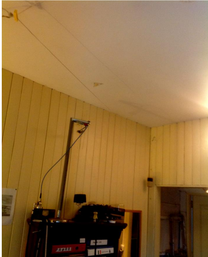
Fig. 6 Het andere been. Het stralende deel hangt voor een deel naar beneden.
