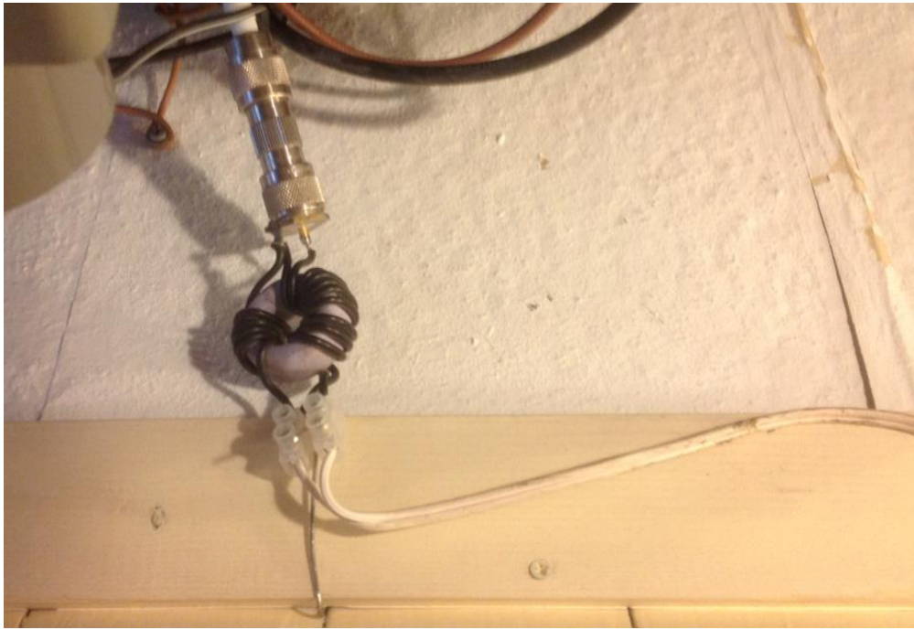
Fig. 2 De 1:1 balun (3 windingen van 5 slagen ieder, op een 6C4 kern) en een stukje transmissielijn.
