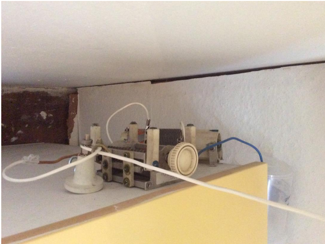
Fig. 8 De LC parallelkring. Hiermee zet je de antenne op de juiste frequentie.
