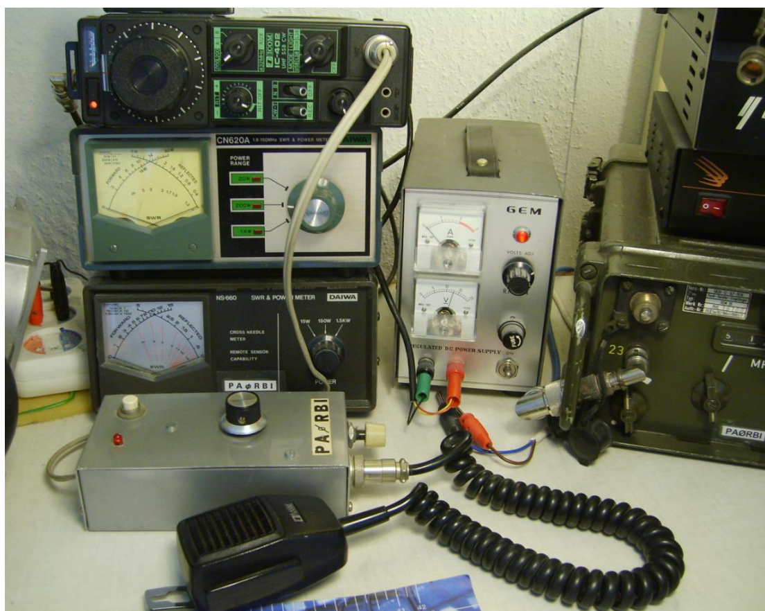
Fig. 2 QRP-station in SSB op 70cm met de oorspronkelijke compressor uit de 70'er jaren.
