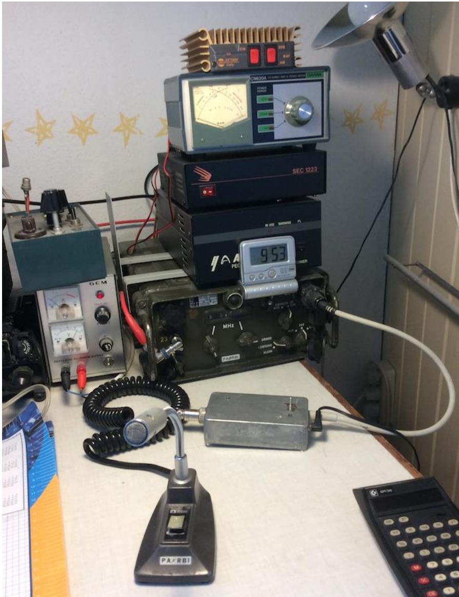
Fig. 3 Compressor met de SEM35. Daarboven staan de eindtrap voor 6m, een voeding en een eindtrap voor 10m. Beiden leveren 30W, goed voor een 30km bereik op de V2000. De gebruikte luidspreker valt net buiten het beeld
