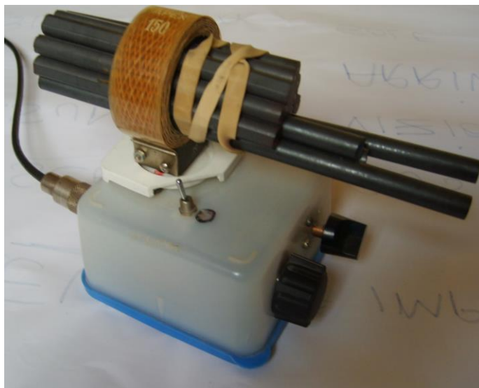
Met honingraadspoel nummer 150 (1920) en de juiste staven, kom je op de LG-omroepband en met geluk, op 137kHz.
