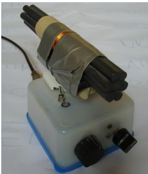
Twintig windingen op 7 staven is voldoende voor de 80 en 160m band.
