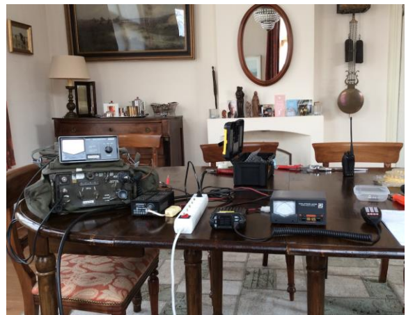
Fig. 4 Opgestelde meetapparatuur: SEM35, KT8900D, SWR-meters, en een voeding.
