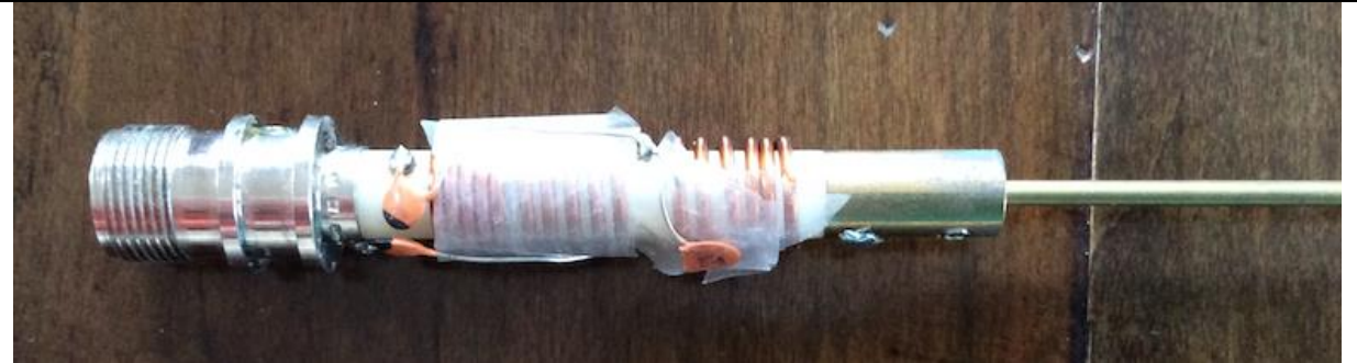
Fig. 2 Spoelsectie in de voet van de antenne, hier al met maatregelen om doorslag te vermijden.
